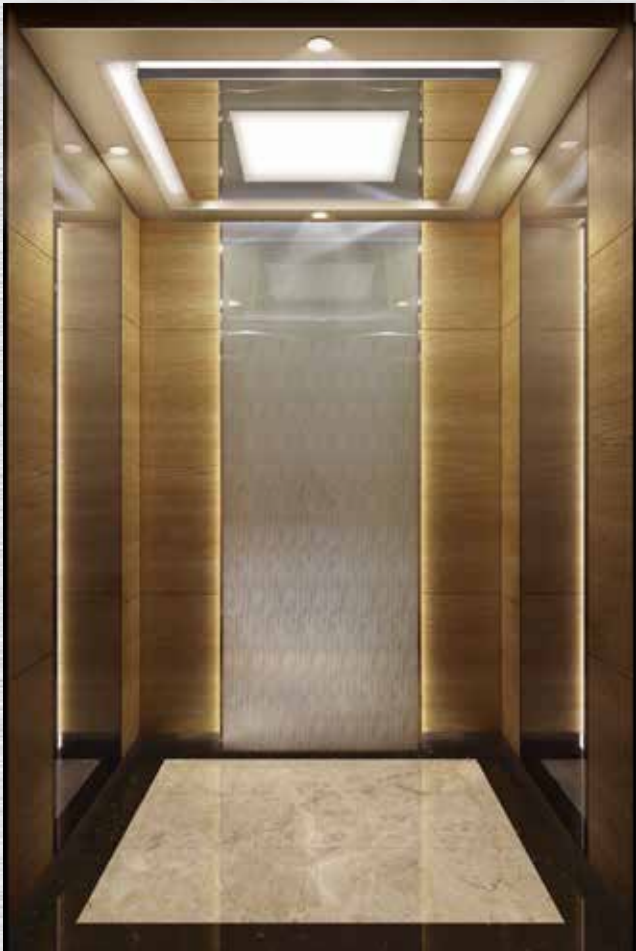
天花板 CE-e4 发纹+镜面不锈钢 轿壁 CR-f2 两侧壁板： 木质饰面（横纹水曲柳）、 中间镜面不锈钢+金属装饰条 后侧壁板： 两侧木质饰面、中间夹绢丝玻 璃（可定制图案）、LED灯带 +金属装饰条 前壁板： 发纹不锈钢 轿门、门楣 发纹不锈钢 地板 BD-c1（拼花地板） 地坎 不锈钢 换气扇 横流风扇 木质饰面 （横纹水曲柳）
